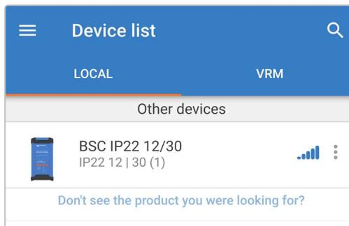
6. Durante la prima connessione appare una "Richiesta di accoppiamento con Bluetooth", che chiederà il codice PIN del Bluetooth: inserire il PIN predefinito 000000, poi selezionare "Accoppia".
