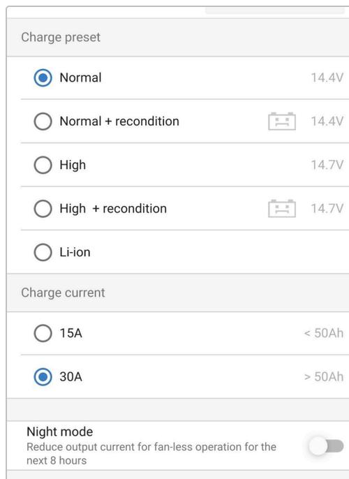
Il caricabatterie memorizza automaticamente la modalità di carica selezionata e la ricorda per i cicli futuri (anche dopo una disconnessione dall'alimentazione).
