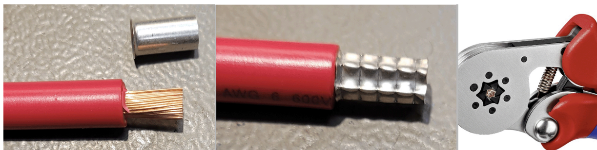
Puntalino a bussola crimpato in modo esagonale
